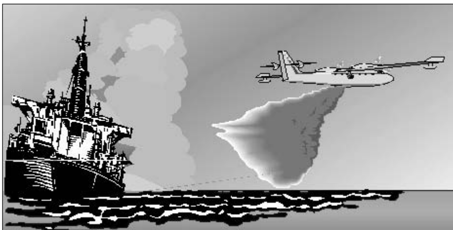
Figura 5 - Sistema de aplicação de dispersantes adaptado para aviões
